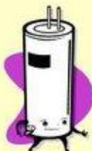
هي ببساطة عبارة عن خزان اسطواني معدني معزول عزلًا حراريًا من الداخل ويوحد به قضبان للتسخين الكهربائي ، بحيث يتم تحويل الطاقة الكهربائية إلى طاقة حرارية خلال وقت قصير نسبياً ويتم ضبط درجة حرارة المياه من خلال ثرمومتر.
